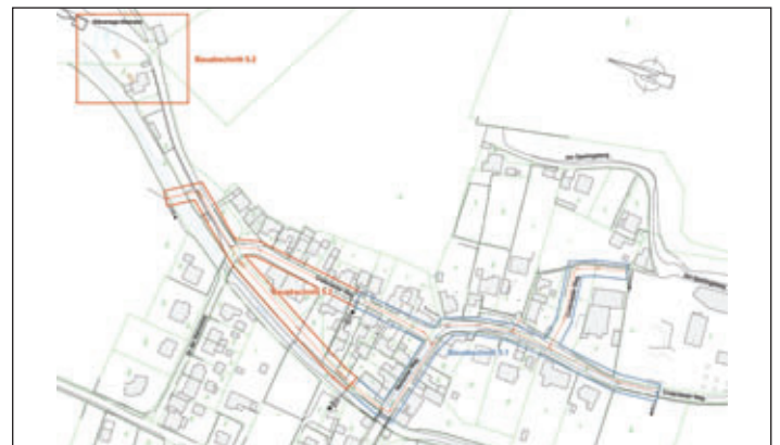
Bauabschnitte Nachhaltiges Wiederaufbaukonzept Meerchenbach in Meerane, „Entflechtung Abwasser-System“, Abschnitt BA 5 – Hauptsammler Crotenlaide / Übersichtsplan: STOLL BAUPLANUNG
